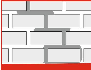
... von Sickerstellen im Mauerwerk und in Betonrohren, zum Verfüllen von Muffenzwischenräumen bei Abflussrohrleitungen
